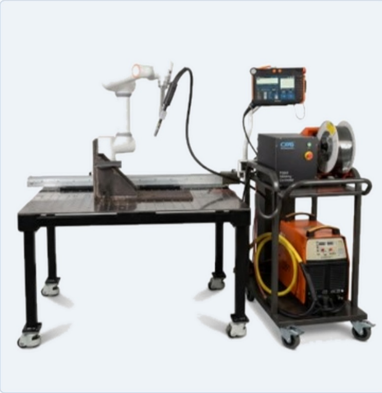
▲ CMG X Welder — 로봇 자동 용접 시스템 전경
